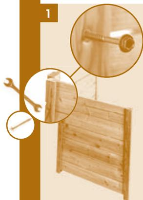
**1.** Assemblage des côtés et du dos : enfiler les tire-fonds dans les trous et visser avec la clé de 8.
